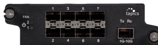
Jumper SP 8 ports de SPAN - double sortie
